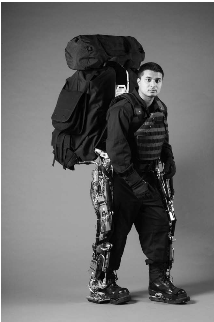
Figuur 5: De Bleexo is een exoskeleton voor militairen die ze in staat stelt om een rugzak van 60 kilogram te dragen
