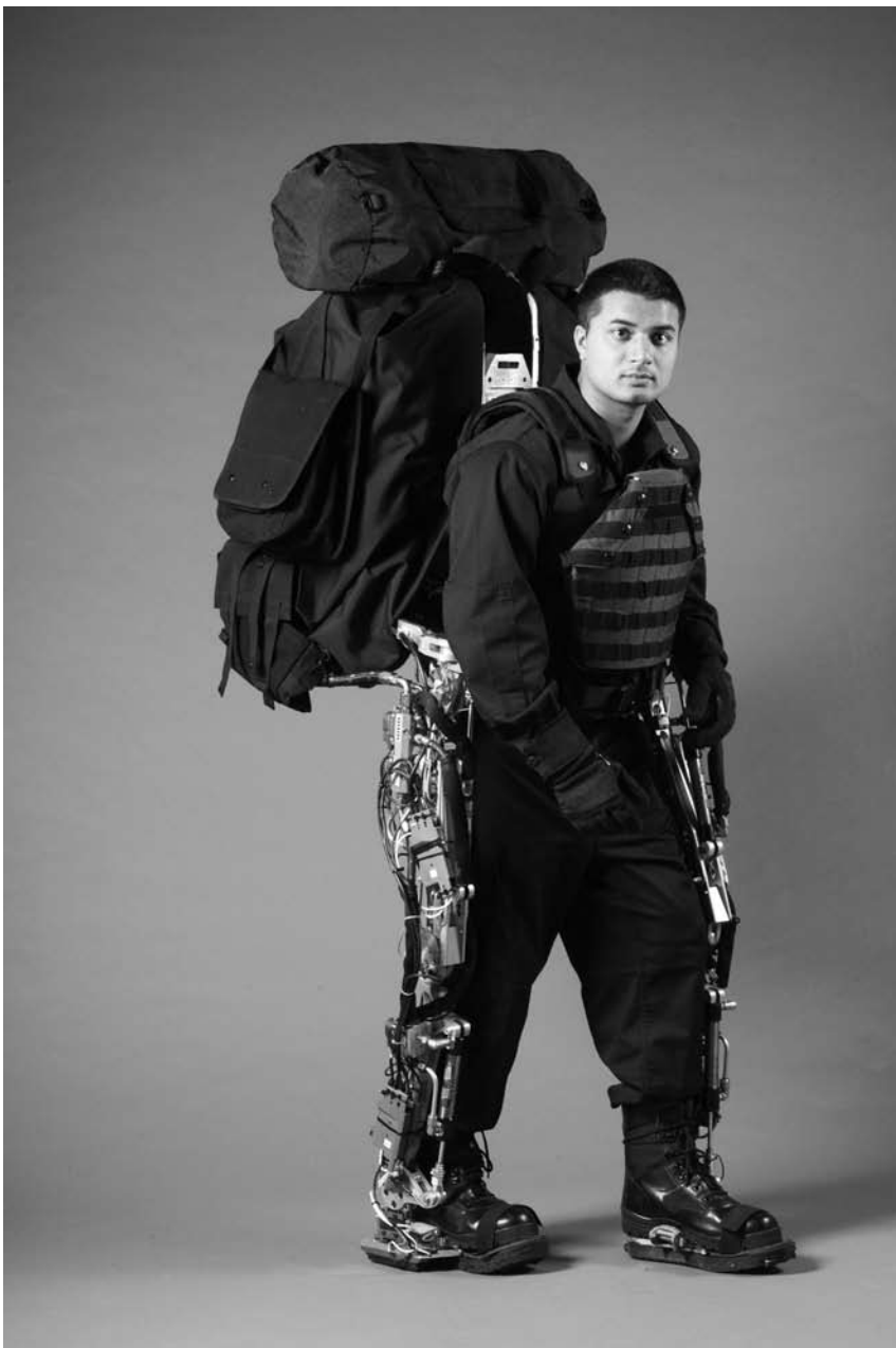
Figuur 5: De Bleexx is een exoskeleton voor militairen die ze in staat stelt om een rugzak van 60 kilogram te dragen
