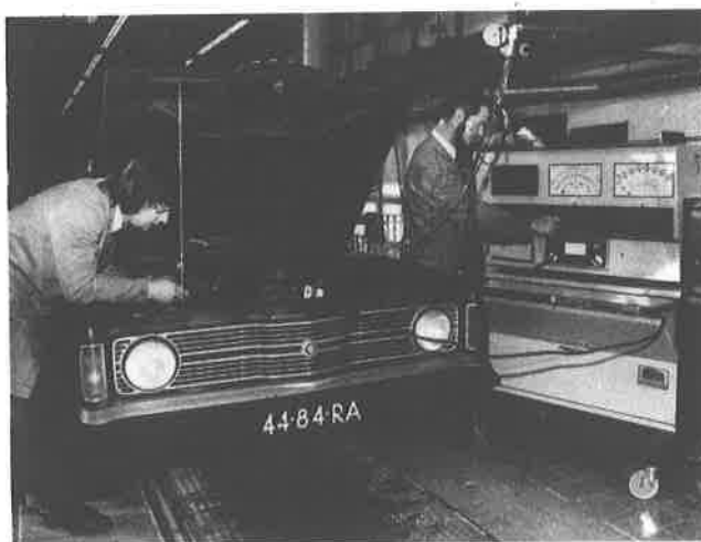
Gebruik van een oscilloscoop en meetapparatuur in een technostation van de ANWB. In de automobiellndustrie zowel als in garagebedrijven neemt het gebruik van geavanceerde elektronica snel toe. Elektronische meetapparatuur is al langer gebruikelijk in het autobedrijf, maar de mogelijkheden voor vernieuwingen en verbeteringen op dit gebied zijn nog niet uitgeput. (Foto: ANWB)
