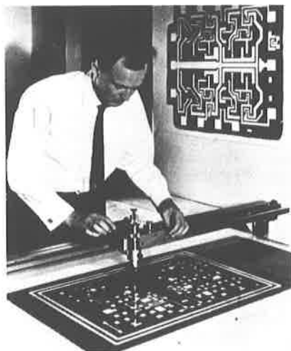
Detail van een «digitizer», waarmee een door de ontwerper gemaakte lay-out van de schakeling wordt gecodeerd in een ponsband. De lay-out is opgespannen op een te- kentafel. Een zogenaamd assenkruis kan in de x-(horizontaal) en in de y-(verticaal) richting over de tafel worden verplaatst. Met behulp van een loep kan men nauwkeurig positioneren. Met een aantal knoppen kunnen de verschillende commando's en de coördinaten van de afgetaste tekening in de ponsband worden aangebracht. (Foto: Philips).
