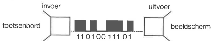
Figuur 2.2: Een digitaal signaal verloopt niet continu. Het bestaat uit «treintjes» enen en nullen waarvan de volgorde natuurlijk wel belangrijk is. De invoer kan via een normaal toetsenbord verlopen, maar allerlei andere methoden zijn ook mogelijk. De uitvoer is vaak een beeldscherm. Analoge signalen kunnen in digitale worden omgezet en omgekeerd.
